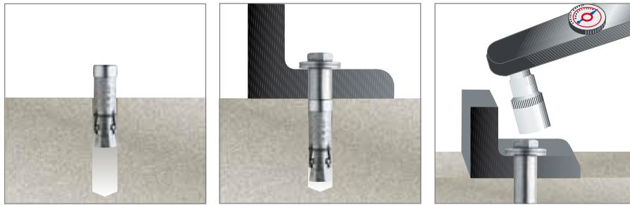
**FISSAGGIO ANCORANTE CON FILETTATURA ESTERNA (MASCHIO) O CAMICIA D'ESPANSIONE**
